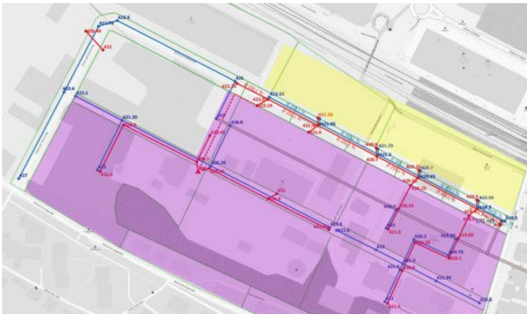
Concept d'évacuation des eaux (variante retenue), Holinger, 2020
