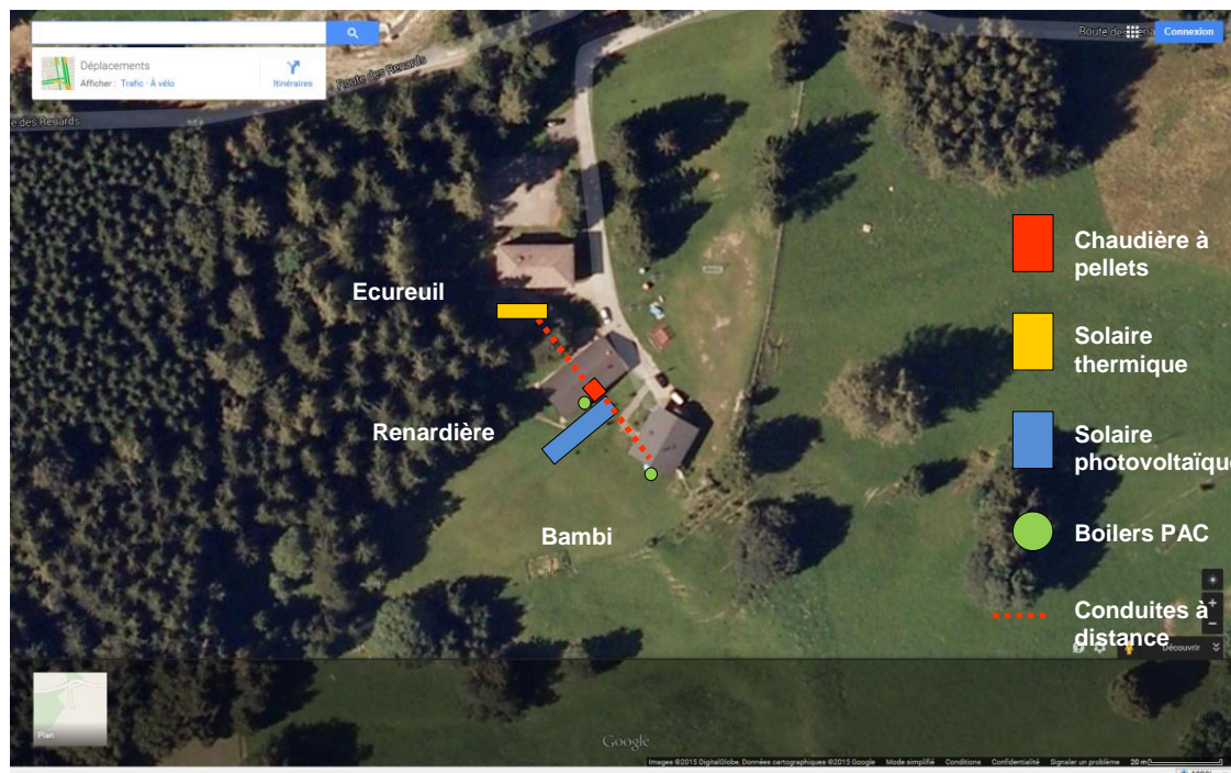
Figure 2: plan de situation des bâtiments et des installations techniques futures de Plan-Sépey
